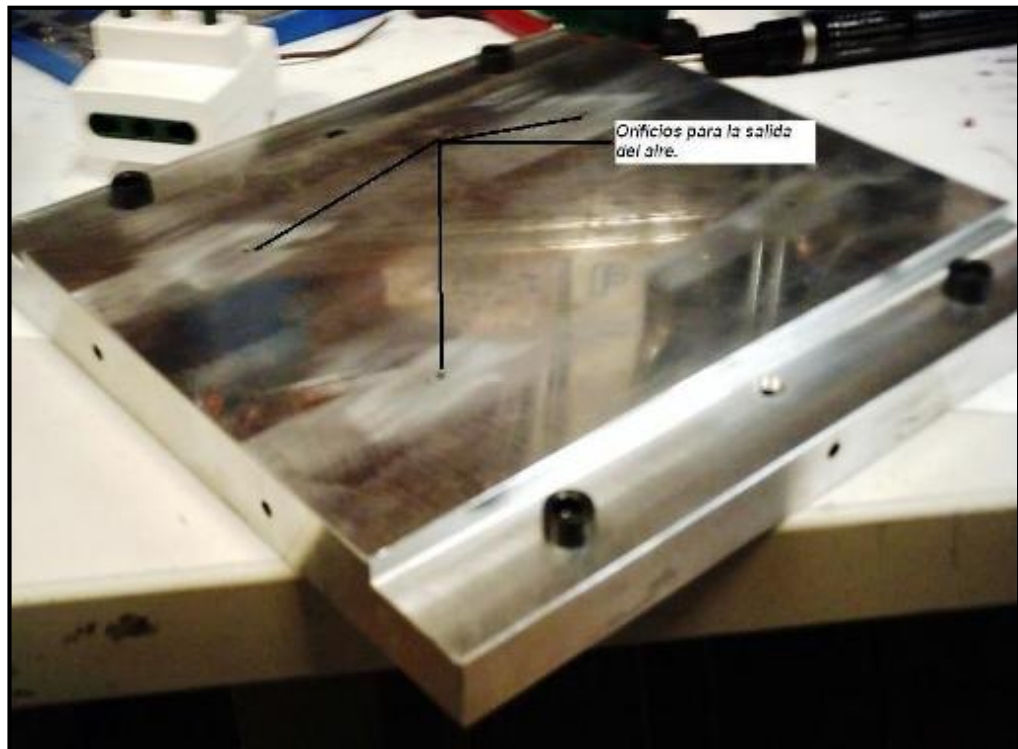
Anexo C5: Fotografía de los elementos estructurales (tapa de la cajuela)
